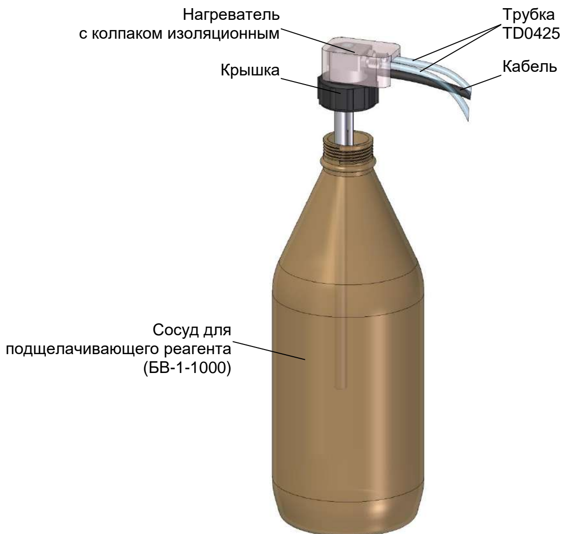
Рисунок 2.13 – Заливка подщелачивающего реагента в сосуд гидропанели ГП-1002Т
