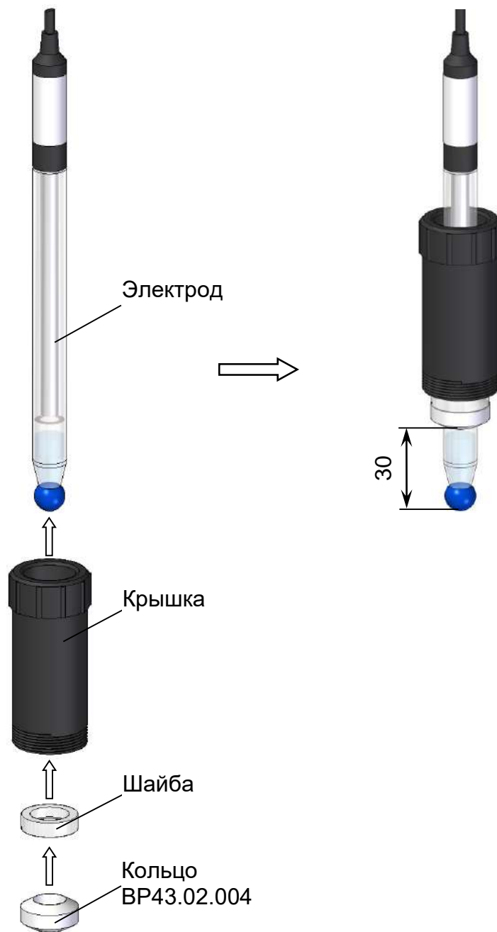
Рисунок 2.8 – Подготовка натриевого и рН-электродов
